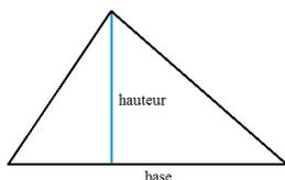
L'aire du triangle est  $\frac{\text{base} \times \text{hauteur}}{2}$ .
