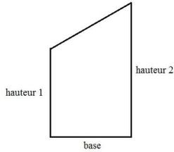
L'aire du trapèze est  $\frac{\text{hauteur 1} + \text{hauteur 2}}{2} \times \text{base}$ .
